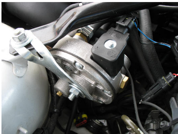
wspornik reduktora, podłączenie elektryczne zaworu odcinającego
